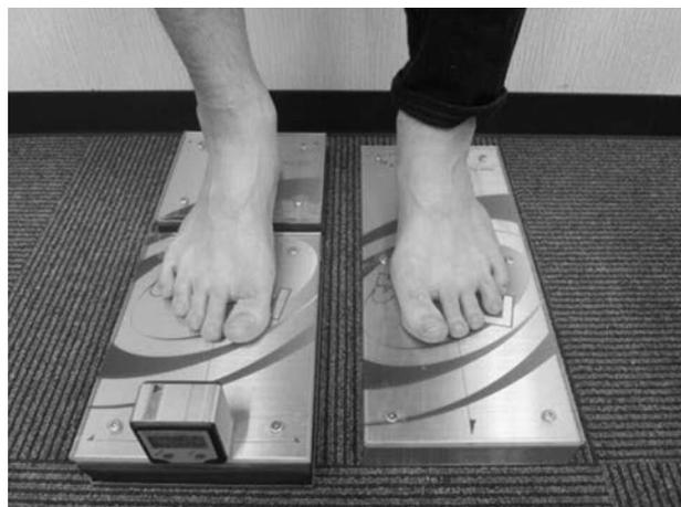
図4. 足部の角度計 (Foot Angle Analysis)
